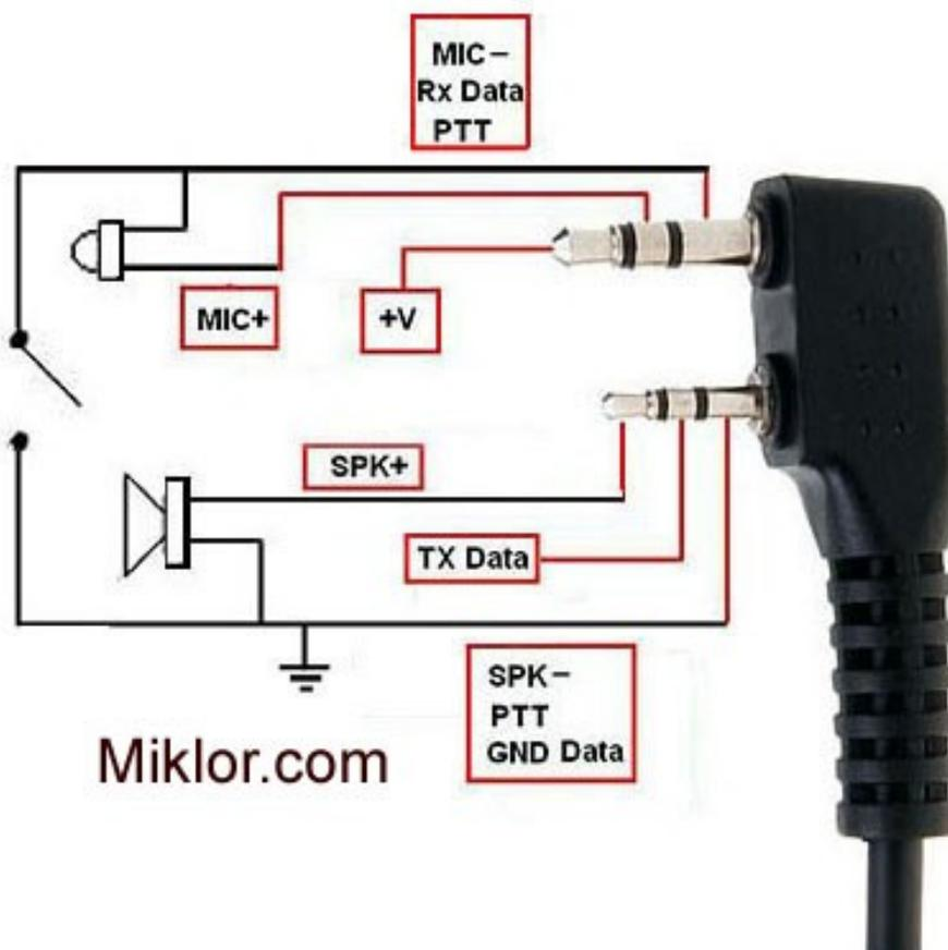
Es ist Folgendes zu beachten: Das Lautsprecher-Signal befindet sich auf dem 2,5mm Klinkenausgang, das Mikrofonsignal wird über den 3,5mm Klinkeneingang eingespeist!
