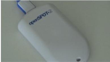
Dieser LED-Zustand wird angezeigt, wenn die openSPOT2 mit der Werkskonfiguration ausgeführt wird. Die Initialisierung dauert etwa 15-20 Sekunden. Access Point (AP) Modus aktiv ist, keine Clients verbunden:
