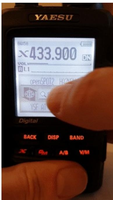
Sie können einen Teil des Servernamen eingeben. Alle passenden Server werden aufgelistet. Um auf einen Server zu wechseln, wählen Sie mit dem Drehknopf und drücken Sie PTT für eine kurze Zeit (oder tippen Sie es, falls Sie einen Touch-Display).
