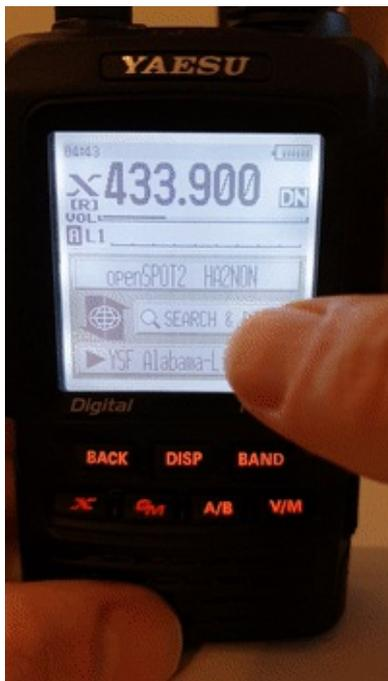
Die ersten 5 Einträge werden Ihre openSPOT2 Konfigurationsprofile sein. Die Liste wird den Server des aktuell aktiven Anschlusses enthält. Falls der derzeit aktive Anschluss nicht über einen Server-Liste (ex. Den Null-Anschluss), YSFReflector Server aufgelistet. Zum Umschalten auf einen Eintrag, wählen Sie es mit dem Rad, und drücken Sie PTT für eine kurze Zeit (oder tippen Sie es, falls Sie einen Touch-Display).
