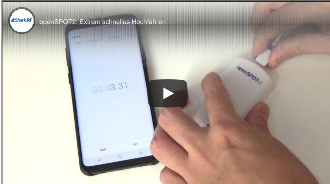
Wenn das Gerät mit der Werkskonfiguration ausgeführt wird, dann gibt es eine Initialisierung für etwa 1520 Sekunden läuft und die LED weiß blinken. Danach wird die LED-Anzeige langsam pulsierenden weiß, dass die Device Access Point (AP) Modus eingegeben hat, und es ist sein eigenes Wi-Fi-Netzwerk namens Rundfunk **openSPOT2 AP**.
