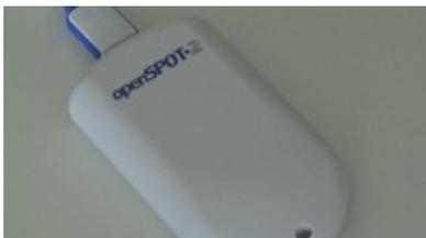
Verbindung zu einem Wi-Fi-Netzwerk sollte ein paar Minuten Zeit nur nehmen. Wenn die LED zu lange dieser Zustand angezeigt wird, dann stellen Sie Sie bitte im **Bereich von einer zuvor eingestellten Wi-Fi-Netzwerk sind, oder schalten Sie AP-Modus durch Drücken der Taste **Taste** 3 Sekunden lang, und wieder eine neue Wi-Fi-Verbindung eingerichtet.** siehe [Anschließen des openSPOT2 mit einem Wi-Fi-Netzwerk](#) Informationen darüber, wie eine Wi-Fi-Netzwerkverbindung im AP-Modus einzurichten.
