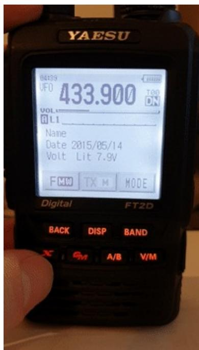
Die openSPOT2 zeigt die aktuell aktive Konfiguration Profilnummer in der unteren rechten Ecke des FT2D Display. Die angezeigten Informationen können von C4FM anders aussehen auf andere Art / Fusion Radios. Die Beispiele sind hier zeigten eine FT2D verwenden.
