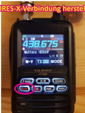
Um eine Wires-X Verbindung herzustellen muss ein C4FM-Relais ausgewählt werden und dann die „GM/X-Taste“ lange drücken.
