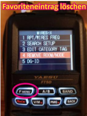
Mit „4 REMOVE ROOM/NODE“ löscht man man Verbindungseinträge. In diesen Punkt kommt man mit „F-MENU“ (länger drücken) und dann „WIRES-X“.
