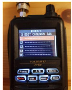
Zum Hinterlegen einer Verbindung als Favorit C1, C2, C3, C4 oder C5 anklicken.
