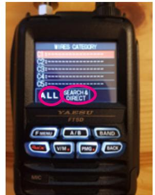
Mit Taste „ALL“ werden alle verfügbaren Relais angezeigt, mit „SEARCH&DIRECT“ einzelne Relais oder Favoriten auswählen.
