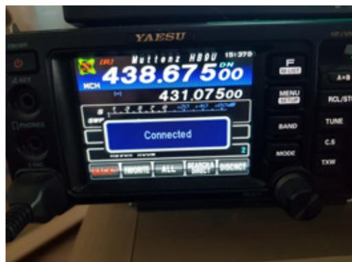
Sobald die Verbindung steht wird dies mit „Connected“ angezeigt.
