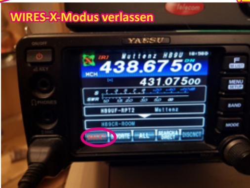
Um den WIRES-X-Modus zu verlassen, auf dem Display „BACK“ drücken.
